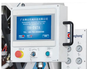
電器箱控制系統 Electrical box control system
