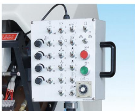
電器箱控制系統 Electrical box control system
