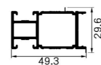
D-A697 Name : c板龙骨 Thickness : 1.8mm Weight : 0.716 kg/m
