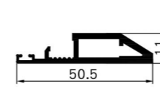
(Styles E) SK673 Name : door frame Thickness : 2.0mm Weight : 0.503 kg/m
